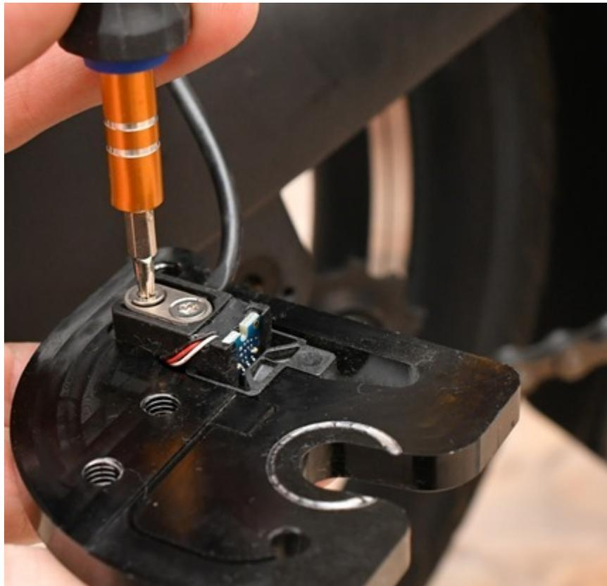
El sensor en sí debe retirarse para limpiarlo bien. Bueno, también tenemos que desmontar todo y luego volverlo a montar ya limpio. Para ello desatornilla los dos tornillos con una ranura "Torx" y retira el sensor del cable.
