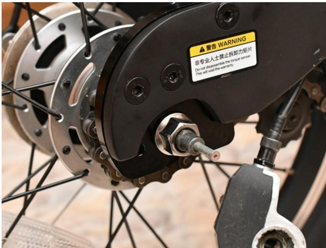
En el montaje tenemos que tener en cuenta la presión que le demos a esos tres tornillos que sujetan el sensor a el cuadro tiene que ser firme pero no demasiado, y cuidar la posición del cambio que al situarlo no presione sobre el sensor.
