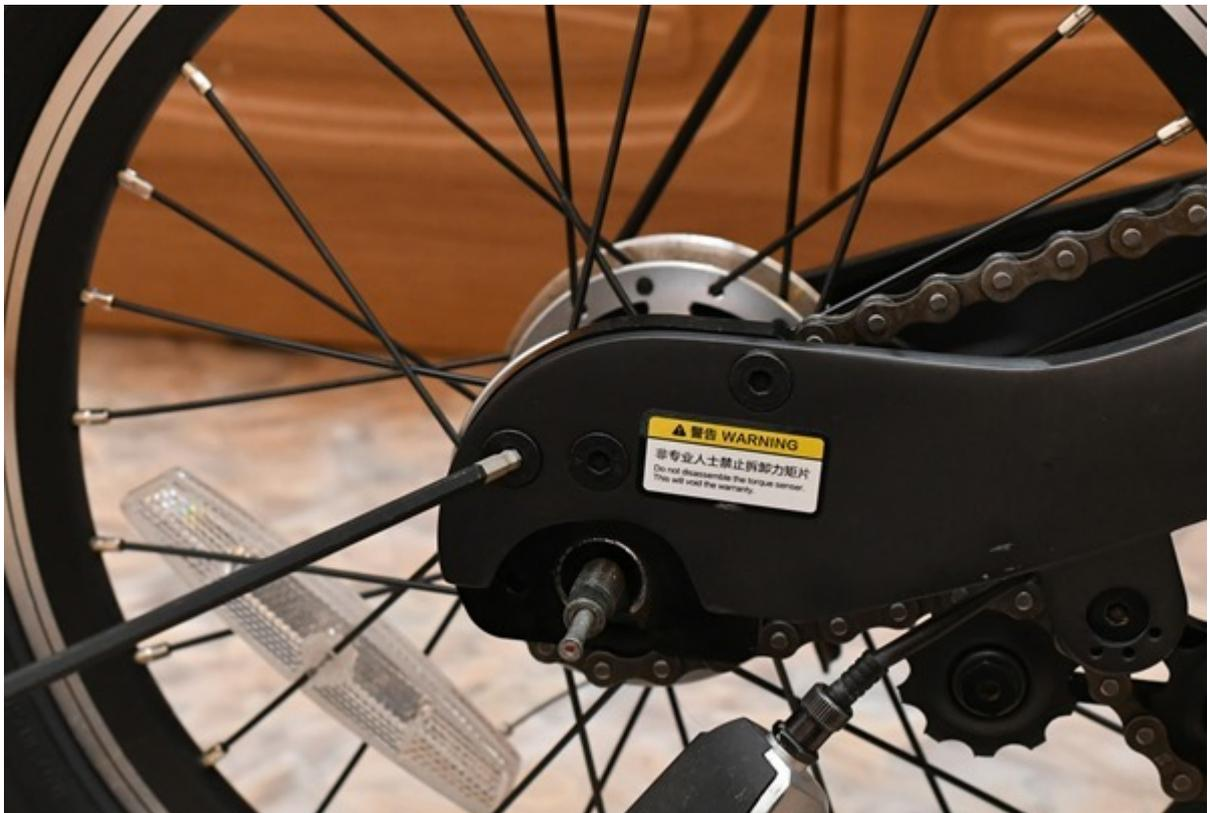
Desenrosca los 3 tornillos que sujetan la placa del sensor al cuadro de la bicicleta.
