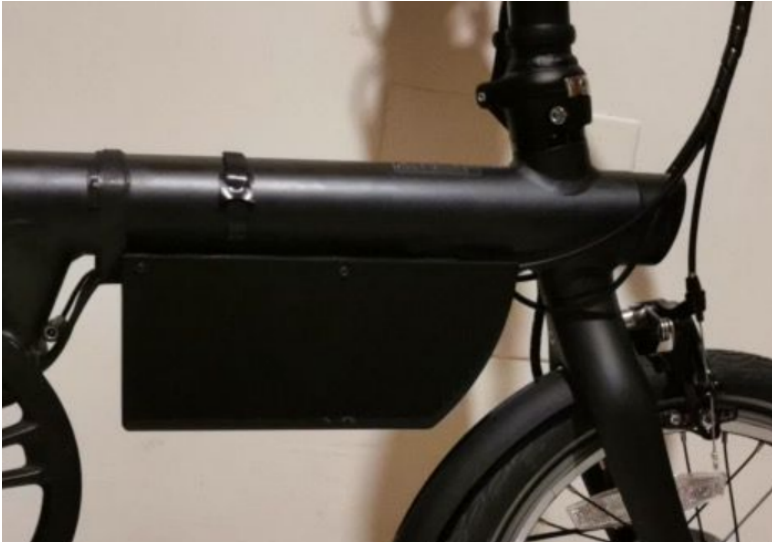
En esta foto podemos ver el soporte de la batería fabricado en 3D.
