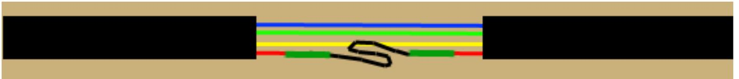
Una vez selladas las soldaduras con el termo retráctil, hacemos un simple pliegado de los cables para proceder a su sellado completo.
