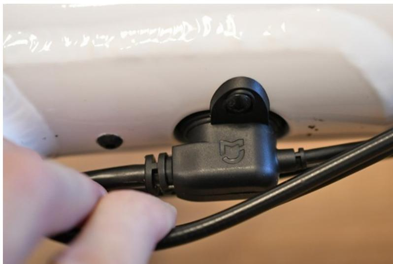
El conector está unido con dos tornillos. Verifica el estado de ambas partes del conector.
