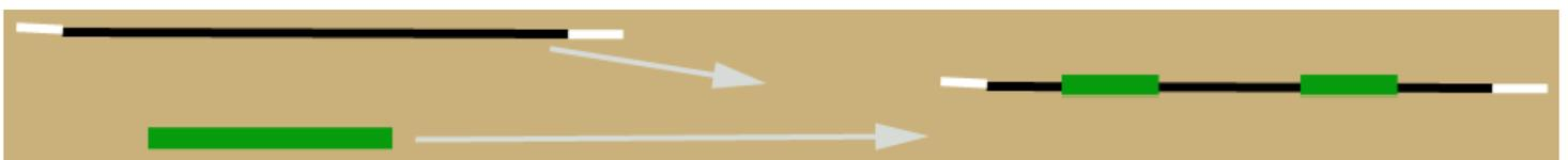
Pelamos un cable las dos puntas y metemos en el dos trozos de termo retráctil, para sellar la soldadura una vez hecha.
